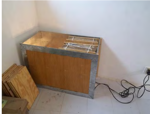
Figura 25. Secadora de campo de 100 cm x 50 cm x 70 cm, con 8 sockets y conexión eléctrica.
